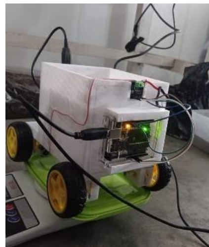
Gambar 4. Mobile robot tampak belakang dengan Arduino Uno
