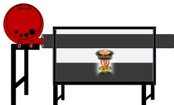
Gambar 3. Skema kompor pengering ikan teri berbasis gas lpg.
