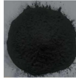
Gambar 3. Serbuk Tempurung Kelapa setelah diayak menggunakan mesh 50
