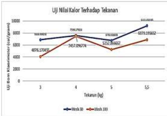
Gambar 4. Hasil Penyetaraan Massa Nilai Uji Bomb kalorimeter Terhadap Tekanan
