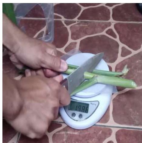
Gambar 3. Analisis gaya potong untuk 1 rumput menggunakan timbangan
