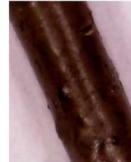
Gambar 14d. Permukaan *filament* pemanasan di atas 1jam
