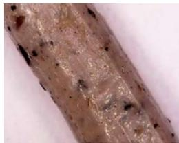
Gambar 13d. Permukaan *filament* pemanasan di bawah 1jam
