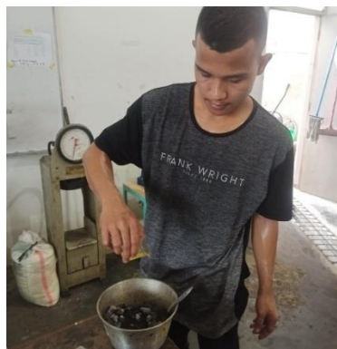
Gambar 7. Pencampuran Agregat, Asbuton dan Pelarut
