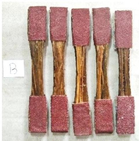
**Gambar 6. Kondisi Spesimen Variasi Pemanasan 90°C Sebelum Pengujian, Kode Spesimen (B)**
