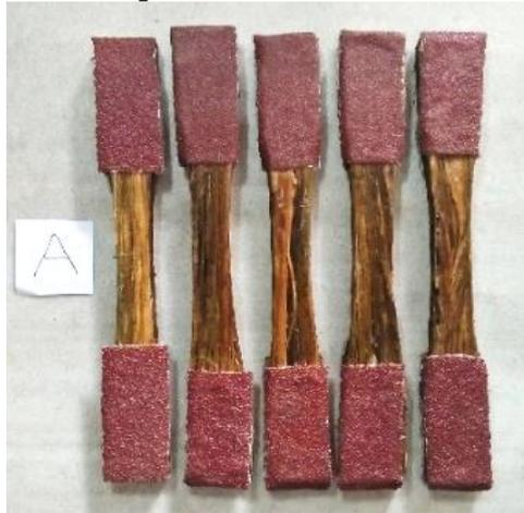
**Gambar 4. Kondisi Spesimen Variasi Tanpa Pemanasan Sebelum Pengujian, Kode Spesimen (A)**
