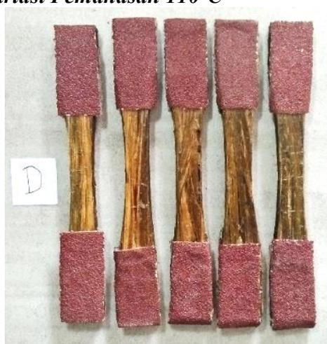
**Gambar 10. Kondisi Spesimen Variasi Pemanasan 110°C Sebelum Pengujian, Kode Spesimen (D)**
