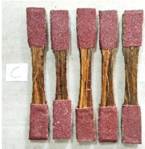
**Gambar 8. Kondisi Spesimen Variasi Pemanasan 100°C Sebelum Pengujian, Kode Spesimen (C)**
