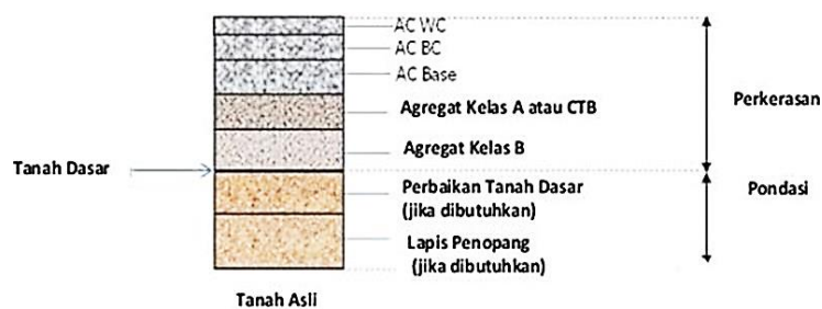
Gambar 8. Konstruksi Perkerasan Lentur
