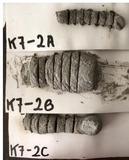
Gambar IV-9 Hasil Extrude Test Variasi 7% Ukuran Serat 2mm (Sumber : dokumentasi pribadi)
