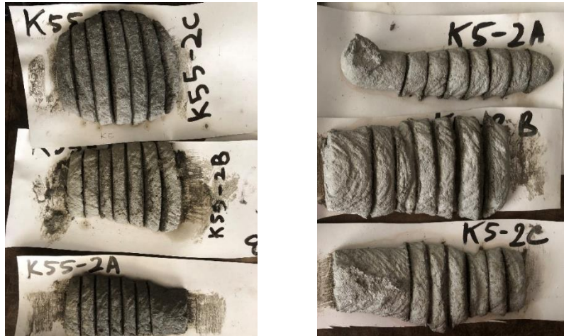
Gambar IV-7 Hasil Extrude Test Variasi 5% dan 5,5% Ukuran Serat 2mm (Sumber : dokumentasi pribadi)
