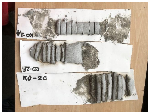
Gambar IV-10 Hasil Extrude Test Variasi 0% Ukuran Serat 2mm (Sumber : dokumentasi pribadi)
