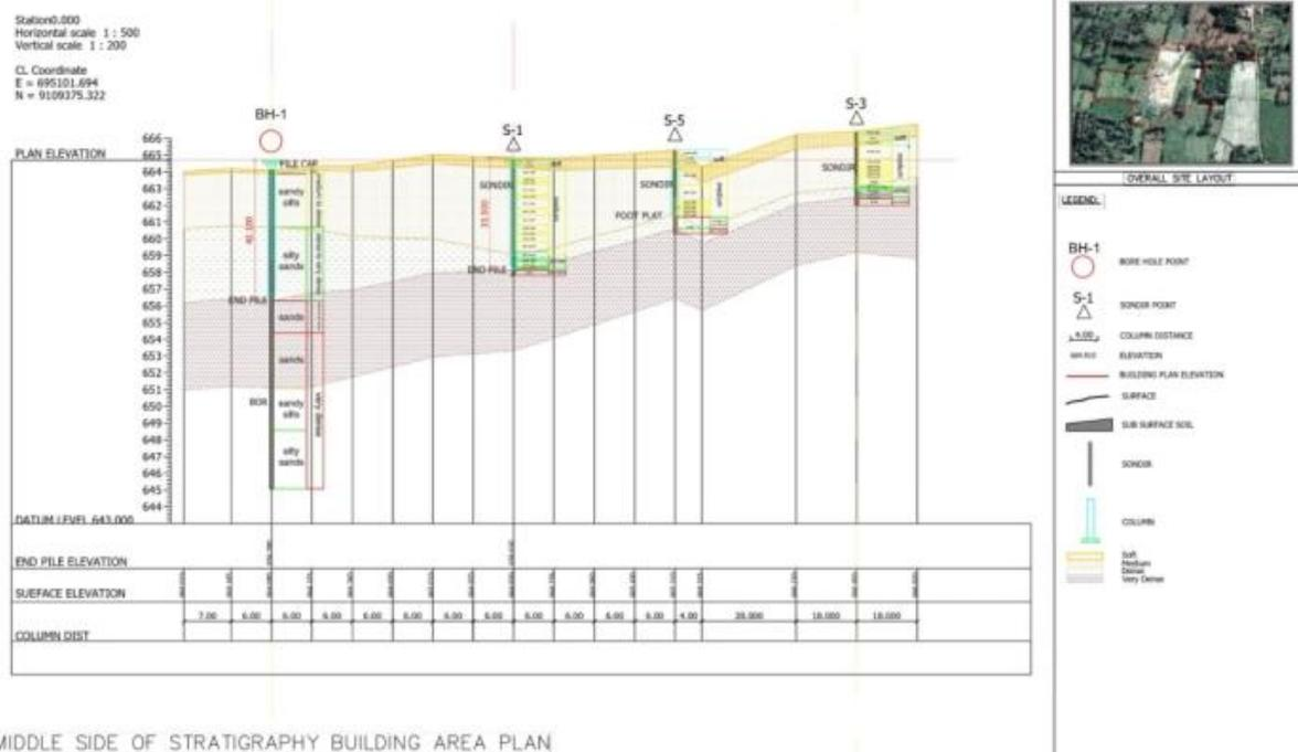
Gambar 4.1: Lapisan tanah pada lokasi titik sondir pada bangunan utama
